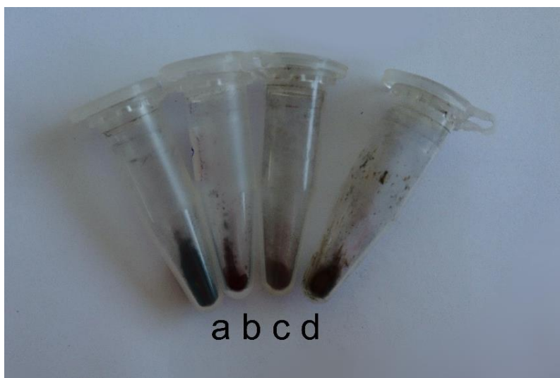
Figura 19. Polvos de a) nanopartículas de magnetita desnudas, b) M-PEG, c) M-Q y d) M-PVP
