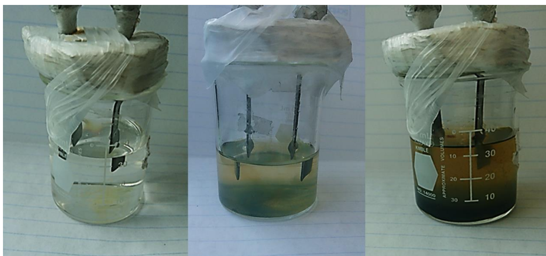
Figura 12. a) Celda electroquímica al inicio de la síntesis, b) después de 10 min y c) al finalizar las 2 horas
