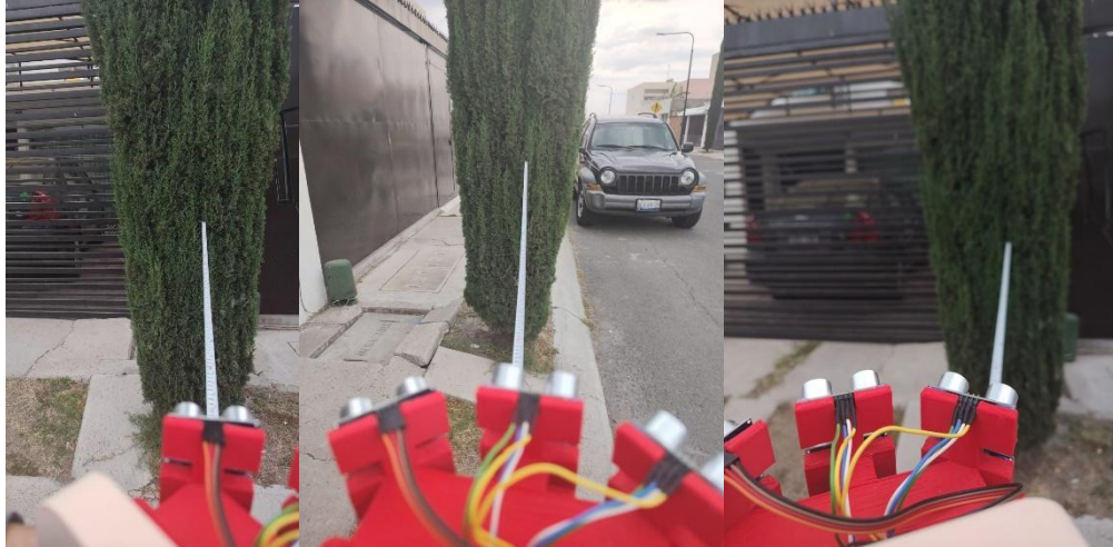
Figura 4.4 Medición con los sensores en 3 posiciones diferentes con un árbol (imagen por elaboración propia).
