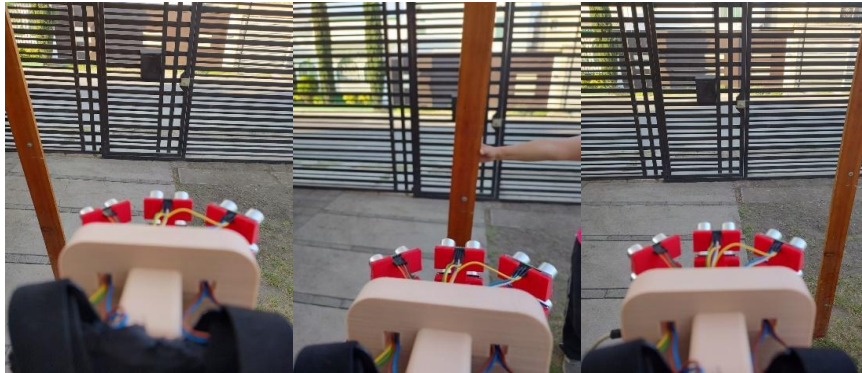
Figura 4.2 Prueba de funcionamiento de matriz de sensores en diferentes posiciones con prisma rectangular (imagen por elaboración propia).
