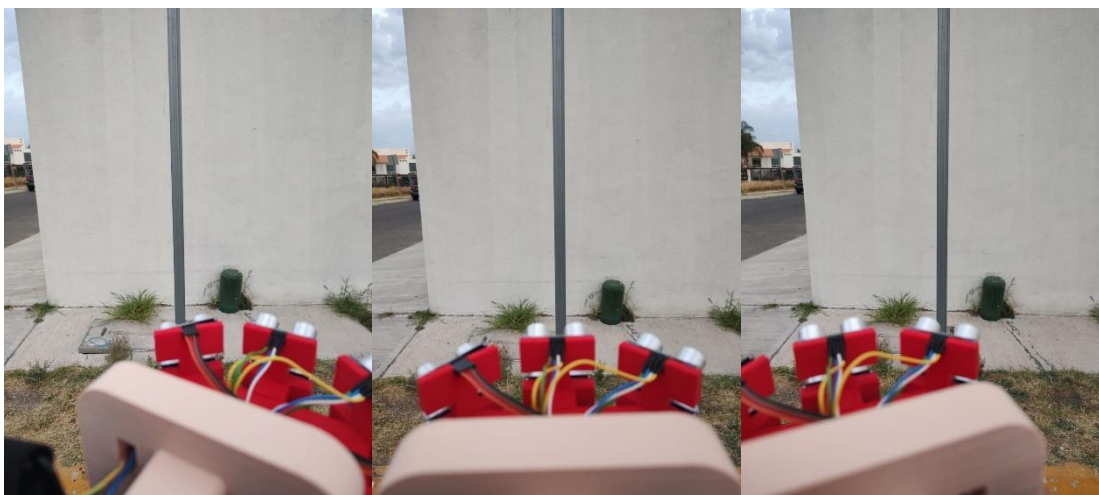
Figura 4.6 Medición con los sensores en 3 posiciones diferentes con una señal de alto (imagen por elaboración propia).
