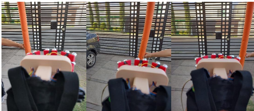
Figura 4.3 Prueba de funcionamiento de matriz de sensores en diferentes posiciones con cilindro (imagen por elaboración propia).
