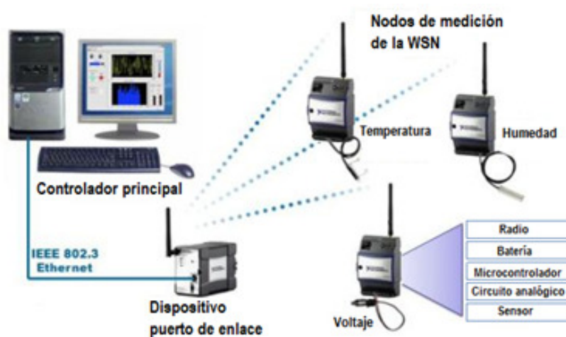
Figura 2. 7. Arquitectura común de una red de sensores inalámbrica punto-multipunto o tipo estrella.
