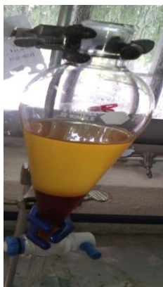
Figura 4.14 Separación del biodiesel y glicerina por gravedad (Elaboración propia)
