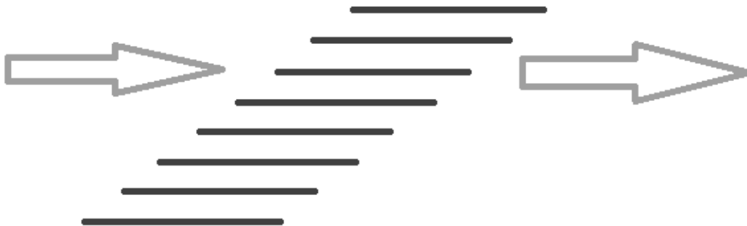
Figura 3. Desplazamiento de las láminas de carbón por exfoliación rotacional.
