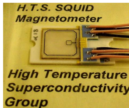
Figura 2.4. SQUID empleado en Magnetómetros con materiales superconductores ( (Magaña S, 2012)
