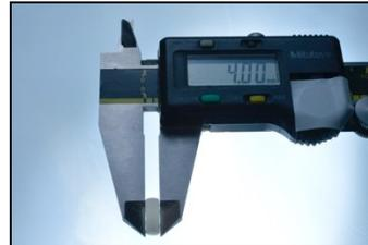
Se realizó el pulido de las muestras mediante discos Sof-Lex® (3M ESPE) para eliminar ligeras asperezas y excedentes y se volvió a verificar con el vernier electrónico.
