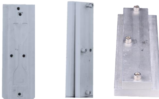
Fig. 6. Molde de acero inoxidable, para elaboración de espécimen de RD.
