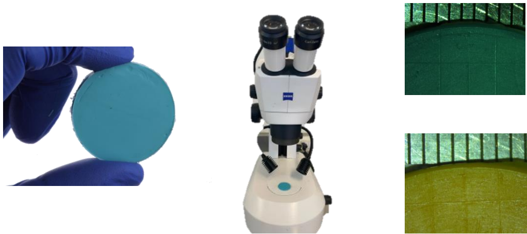
Fig. 9. Especímenes analizados en microscopio, la imagen de la derecha muestra las capturas que se realizaron para las mediciones correspondientes.
