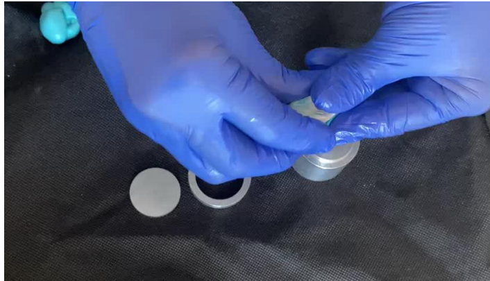
Fig. 4. Manipulación de PVS para ser colocado en el molde de acero inoxidable, de acuerdo a las instrucciones del fabricante.
