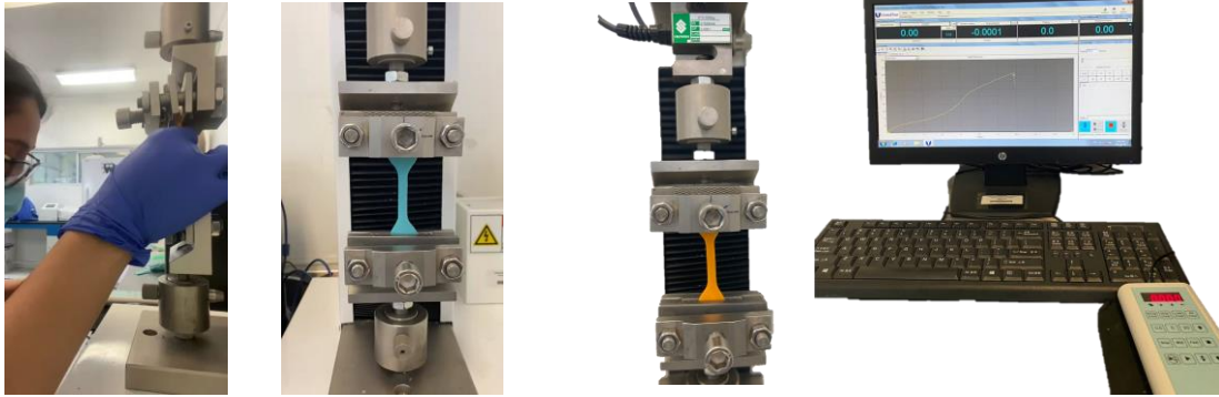
Fig.11. Análisis de especímenes en maquina universal, por medio del desplazamiento de estos y su resistencia al desgarre.
