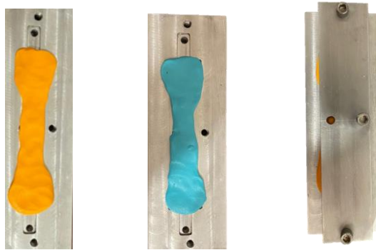
Fig. 6. Elaboración de especímenes con manipulación de acuerdo a instrucciones del fabricante y prensados con un molde de acero inoxidable.
