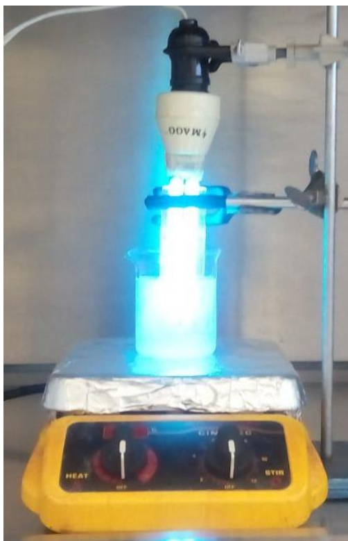
Figura 10. Reactor para oxidación de \text{As}^{3+} .
