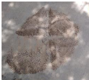
Figura 9. Cuarteo del agregado fino.
