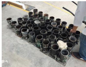
Figura 24. Cilindros de acero con dimensiones 10 cm de diámetro por 20 cm de alto.
