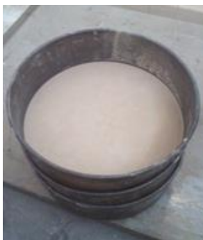
Figura 16. Material que paso la malla no.200
