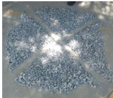
Figura 8. Cuarteo del agregado grueso.
