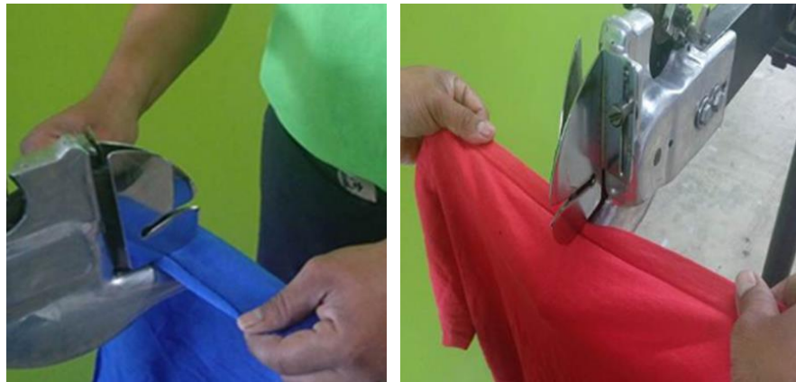
Figura 20. Máquina cortando la ropa en pedazos cuadrados homogéneos.
