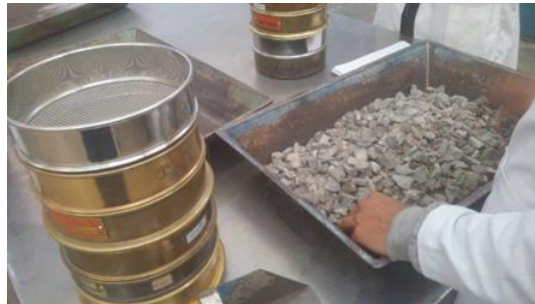
Figura 12. Muestra representativa para ser cribada.
