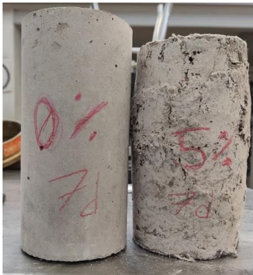
Figura 46. Comparación de cilindro de concreto con sin fibras antes haberse realizado prueba de compresión con cilindro de concreto con 5.0% de fibras después de realizarse prueba de compresión.
