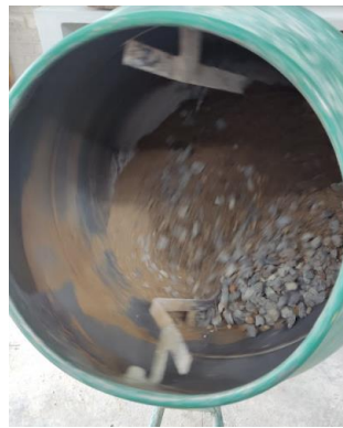
Figura 29. Revolvedora con 50 % del total de grava y el 50 % del total de arena, mezclándose durante 120 segundos
