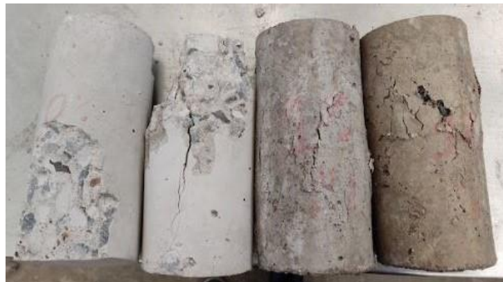
Figura 44. Comparación de fallas a compresión simple de cilindros de concreto con 0.0 y 1.0 % de incorporación de algodón.
