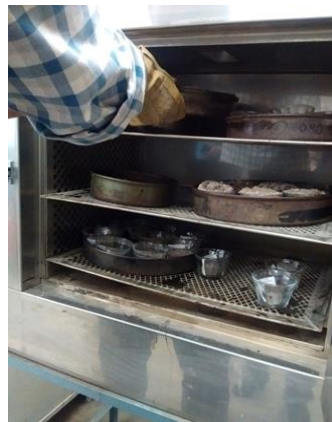
Figura 14. Muestra en horno a 110 \pm 5^{\circ}\text{C} .
