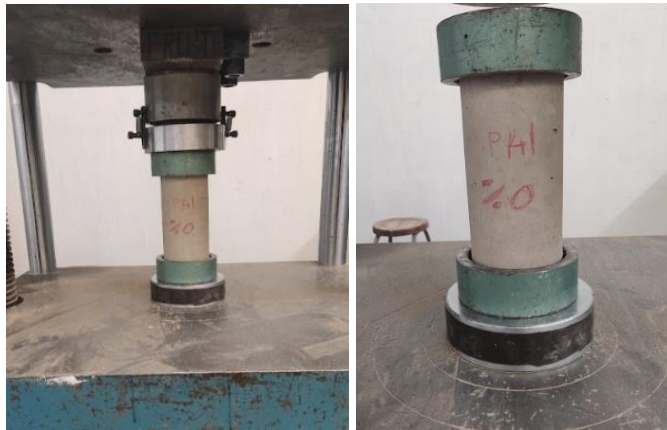
Figura 35. Cilindro de concreto colocado en la maquina universal.
