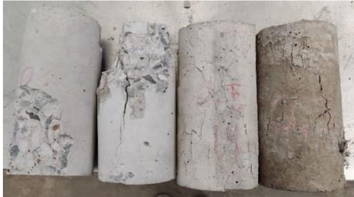
Figura 43. Comparación de fallas a compresión simple de cilindros de concreto con 0.0 y 0.5% de incorporación de algodón.
