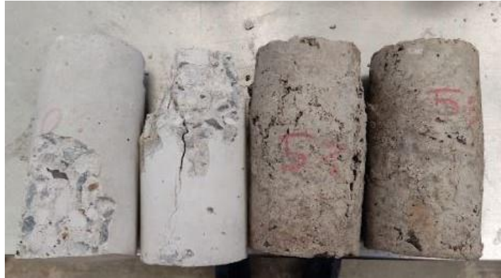
Figura 45. Comparación de fallas a compresión simple de cilindros de concreto con 0.0 y 5.0% de incorporación de algodón.
