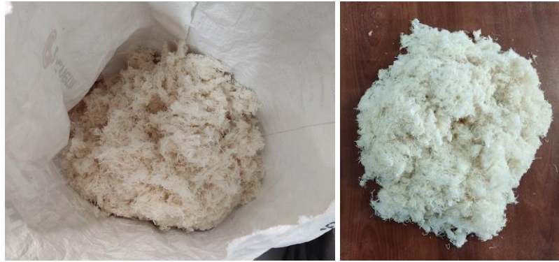
Figura 23. Fibras de algodón de desecho cortadas en longitudes aproximadamente de 10 mm.
