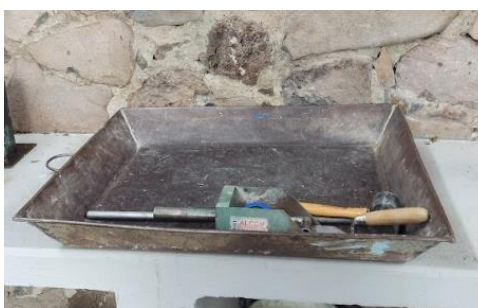
Figura 26. Equipo utilizado para realizar la mezcla de concreto.
