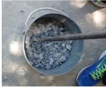
Figura 15. Computación del agregado grueso mediante varillado.
