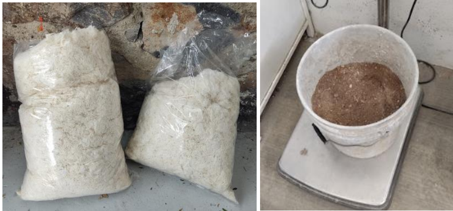
Figura 28. Material utilizado (algodón con longitud de 10 mm y arena).
