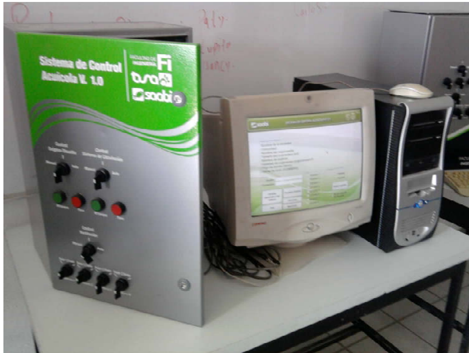
Figura 4.10 Panel de potencia del sistema de automatización acuícola V.1.0
