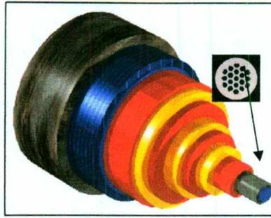
Figura 5: Envoltura térmica de un superconductor semiflexible. Tomado del *ASM Handbook Vol.2, 1991*
