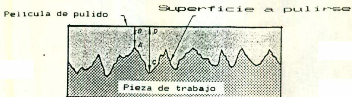
FIGURA 4.1 MECANISMO DE PULIDO ELECTROLITICO [8]
