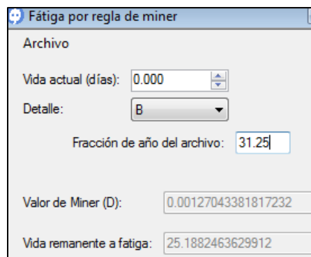
Figura 5.25. Valor de Miner y estimación de Vida a Fatiga. Esfuerzos mediante líneas de influencia. Sección 41.5m. Kervitous.
