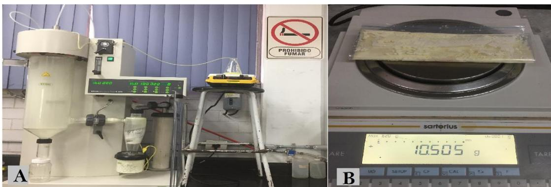
**Figura 16.** A: Equipo Mini Spray Dryer B-290 (Büchi, Switzerland) utilizado para la microencapsulación; B: Medición del peso de las microcápsulas recuperadas del vaso colector para obtener el rendimiento.
