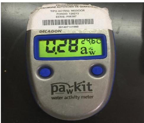
**Figura 17.** Instrumento utilizado para medir la actividad de agua presente en las microcápsulas.
