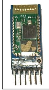
Figura 2-5: Modulo Bluetooth HC-06
