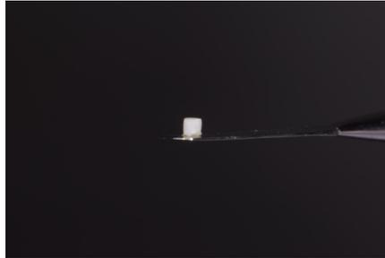
10.- Las 40 piezas fueron sometidas a una fuerza de cizallamiento con la máquina universal tipo Instron ubicada en el laboratorio de la facultad de medicina de la Universidad Autónoma de Querétaro. El procedimiento se realizó a una carga de 5 kN y a una velocidad de 2 cm/minuto, para determinar su resistencia de adhesión.
