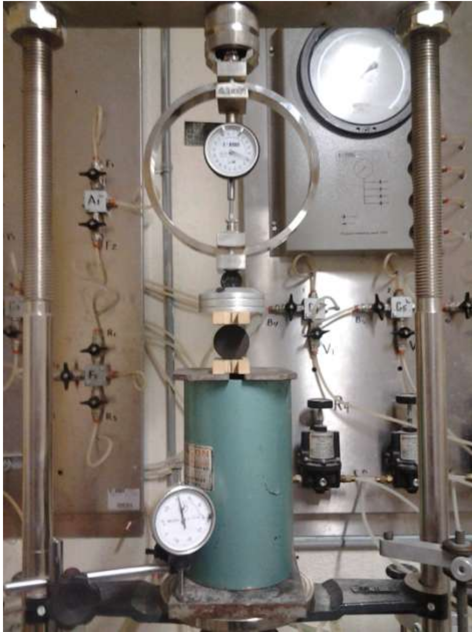
Figura 4-13. Mecanismo de ensayo a tensión indirecta.
