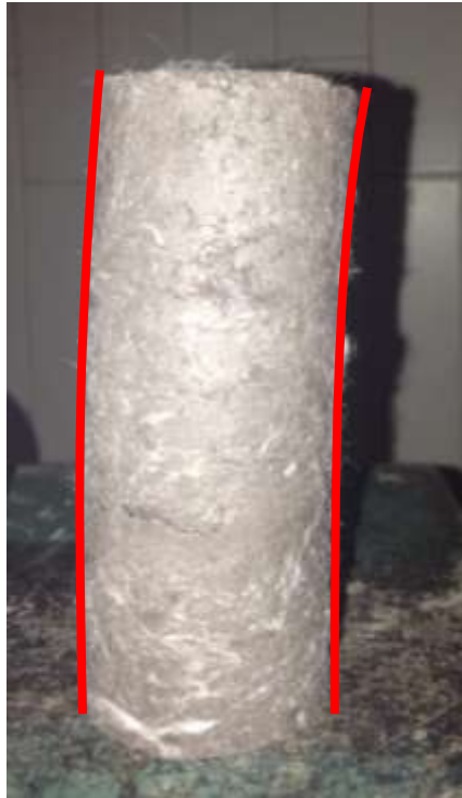
Figura 4-8. Falla por pandeo en las probetas.
