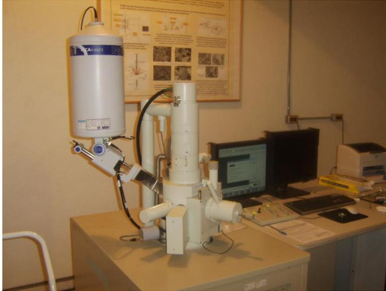
Figura 3.18 Microscopio de barrido electrónico.
