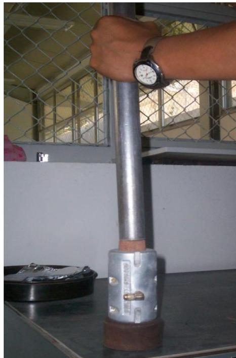
Figura 3.2 Equipo de reproducción de probetas para ensayos de compresión simple.
