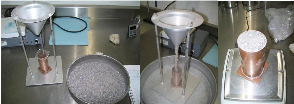
Figura 17 Fotografías de prueba de angularidad del agregado fino.
