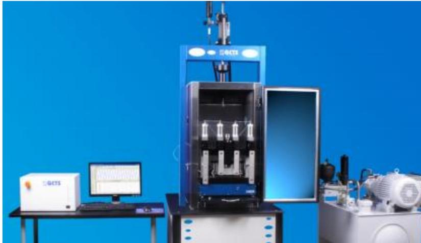
Figura 7 Equipo empleado en el ensayo de fatiga: servo-hydraulic asphalt testing system (astm-025), GCTS.
