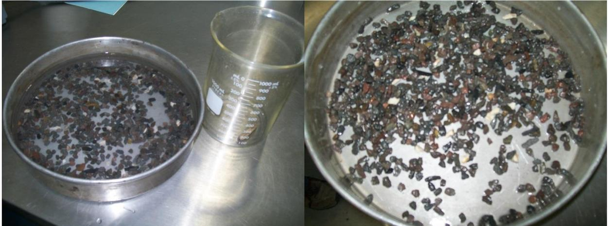
Figura 23 Fotografías del material expuesto ante la solución y posteriormente el material lavado y preparado para su siguiente ciclo.
