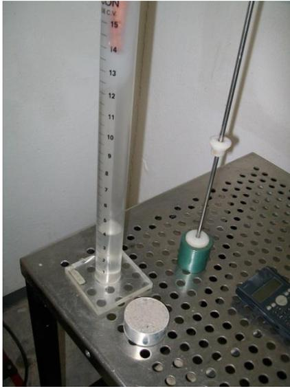
Figura 24 Equipo de prueba para la realización del ensayo de equivalente de arena.
