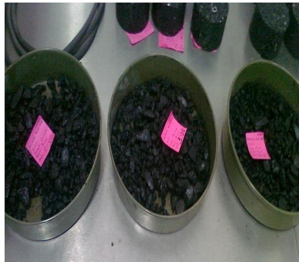
Figura 32 Especímenes de prueba tipo mezcla disgregada.
