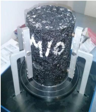
Figura 41 Espécimen de módulo dinámico al momento de colocarle los sujetadores de los sensores.
