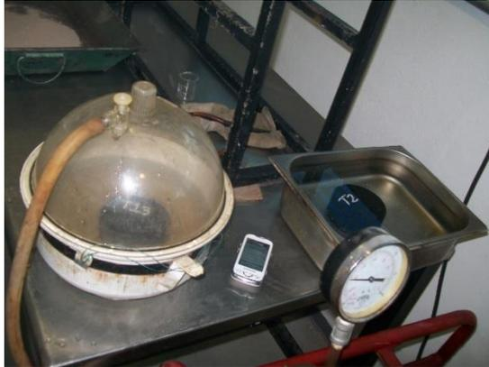
Figura 35 Especímenes saturados al vacío
