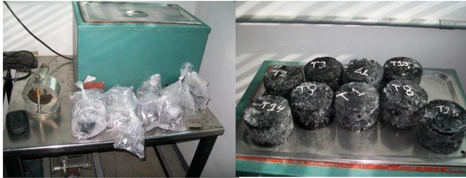
Figura 36 Especímenes acondicionados y listos para el ensaye de TSR
