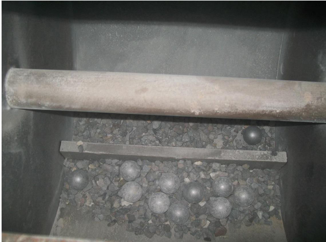
Figura 20 Fotografía tomada de la prueba de desgaste de los ángeles en la cual se puede observar el agregado pétreo dentro del equipo antes de comenzar.
