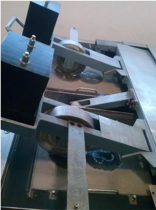
Figura 39 Fotografía tomada durante la ejecución del ensayo de Hamburgo a los espécimenes de prueba.
