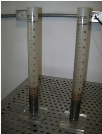
Figura 26 Fotografía tomada durante la realización del ensaye de equivalente de arena no. 2.
