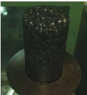
Figura 40 Espécimen de módulo dinámico al salir del molde del compactador giratorio.
