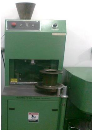
Figura 5 Compactador giratorio propiedad de la empresa SURFAX S.A. de C.V
