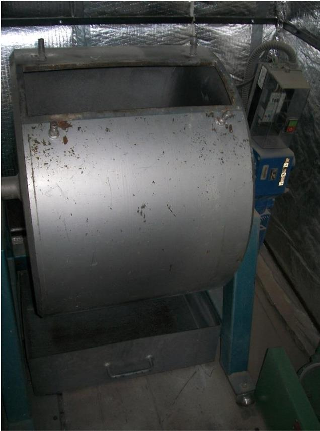
Figura 19 Equipo de ensaye de Abrasión propiedad de la empresa SURFAX S.A. de C.V.
