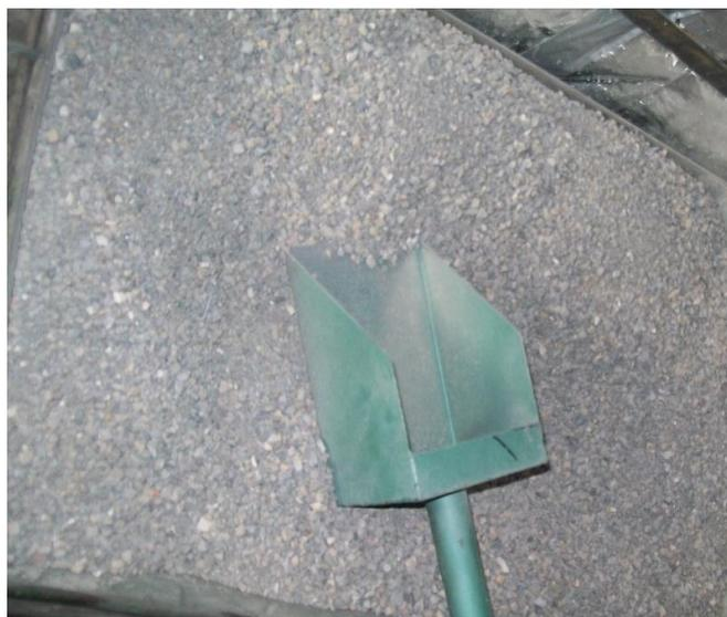
Figura 15 Agregado pétreo del proyecto fracción fina.
