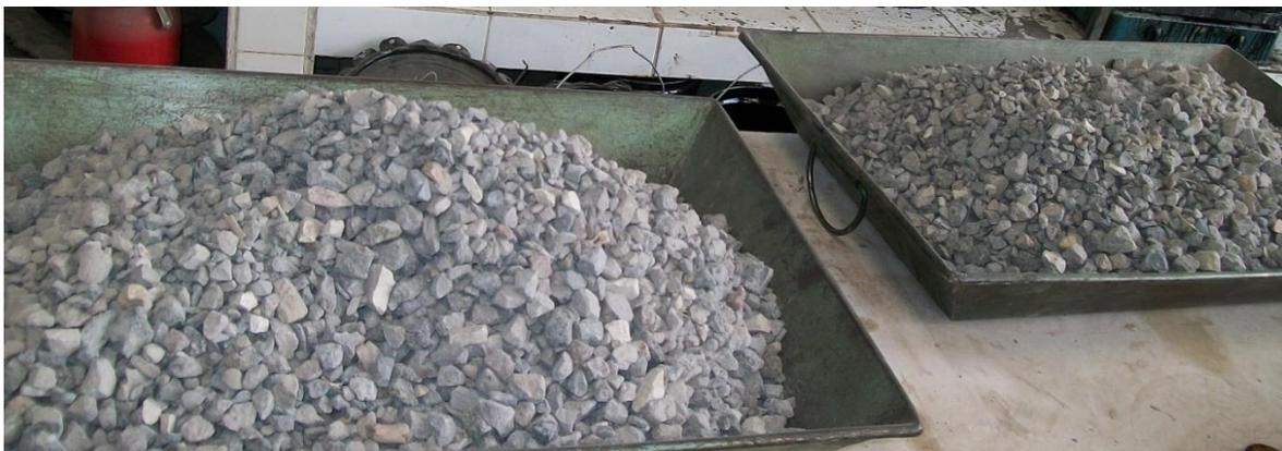
Figura 16 Fotografía tomada al agregado grueso.
