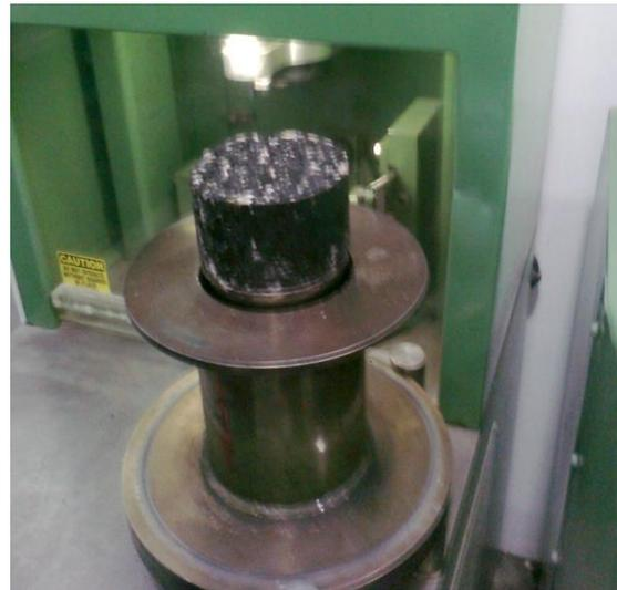
Figura 34 Espécimen tipo pastilla recientemente fabricado y extraído del molde del compactador giratorio.
