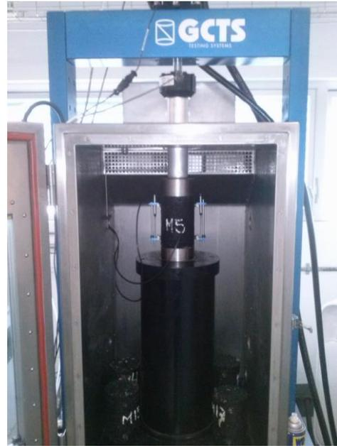
Figura 43 Especimen colocado y listo para la ejecución de la prueba dentro de la cámara de ambientación.
