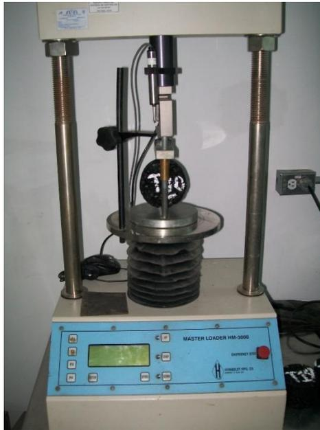
Figura 38 Espécimen y máquina de prueba para TSR
