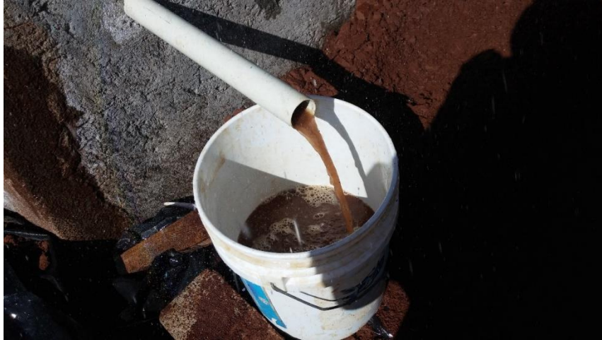
Figura 4.55 Medición de escurrimiento de talud de pendiente constante
