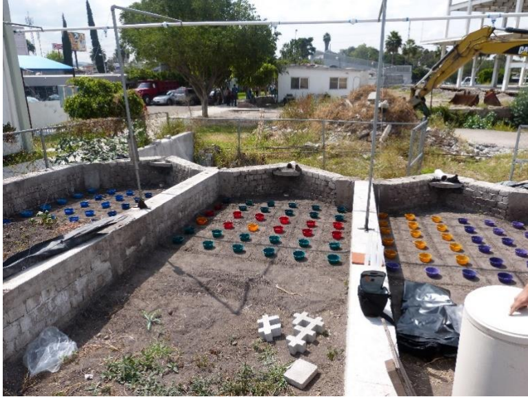
Figura 4.30 Colocación de recipientes para captación de volumen llovido
