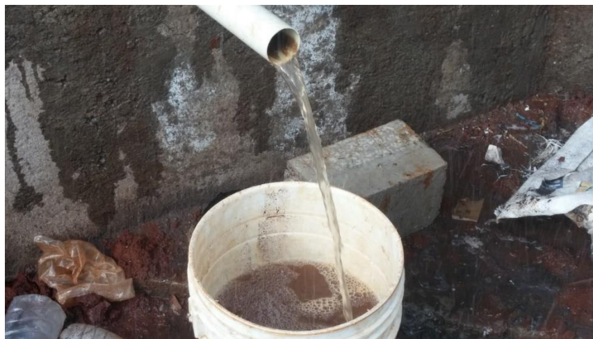
Figura 4.54 Medición de escurrimiento de talud escalonado
