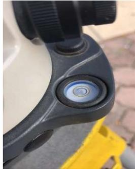
**Figura 40 Nivelación del equipo**
