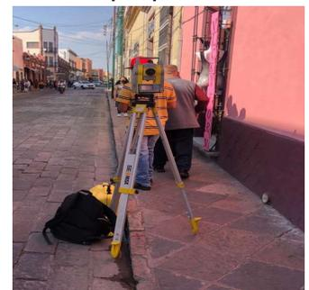
**Figura 82. Levantamiento estación total.**
