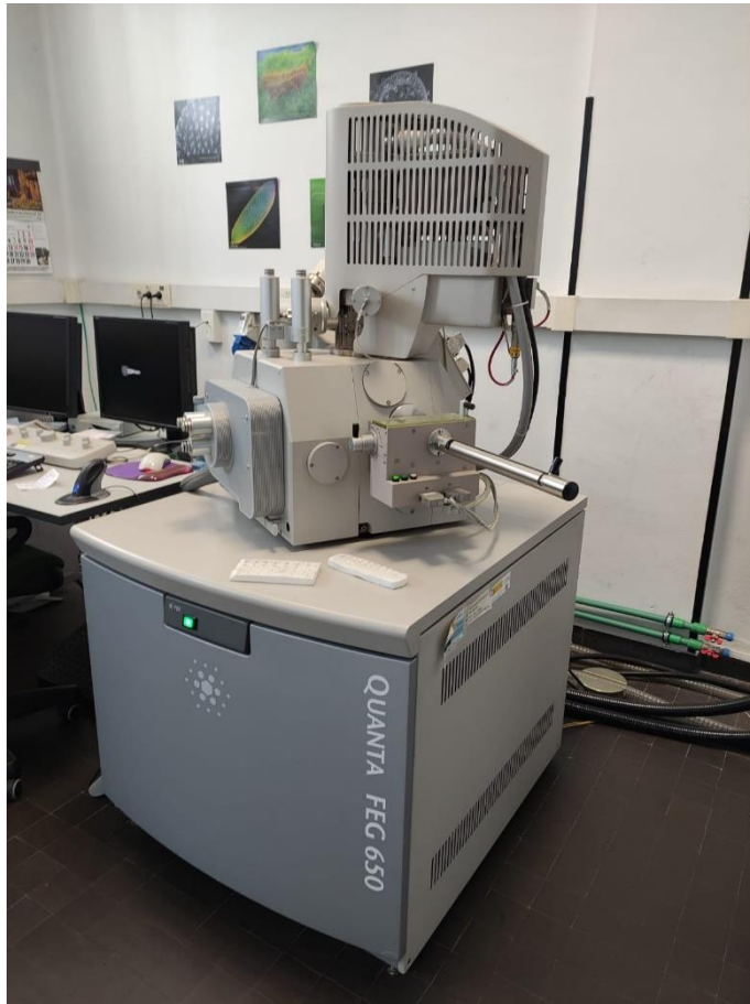
Figura 14. Equipo SEM; SEM, Quanta FEG 650 microscopios de marca FEI, utilizado para muestras de este proyecto
