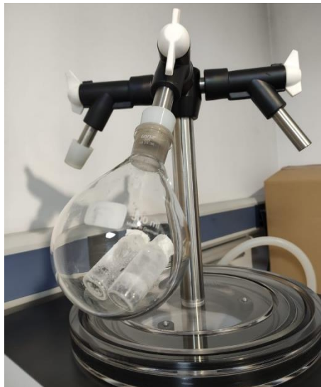
Figura 12. Muestras sometidas en N 2 colocadas en el bulbo y conectadas al liofilizador.
