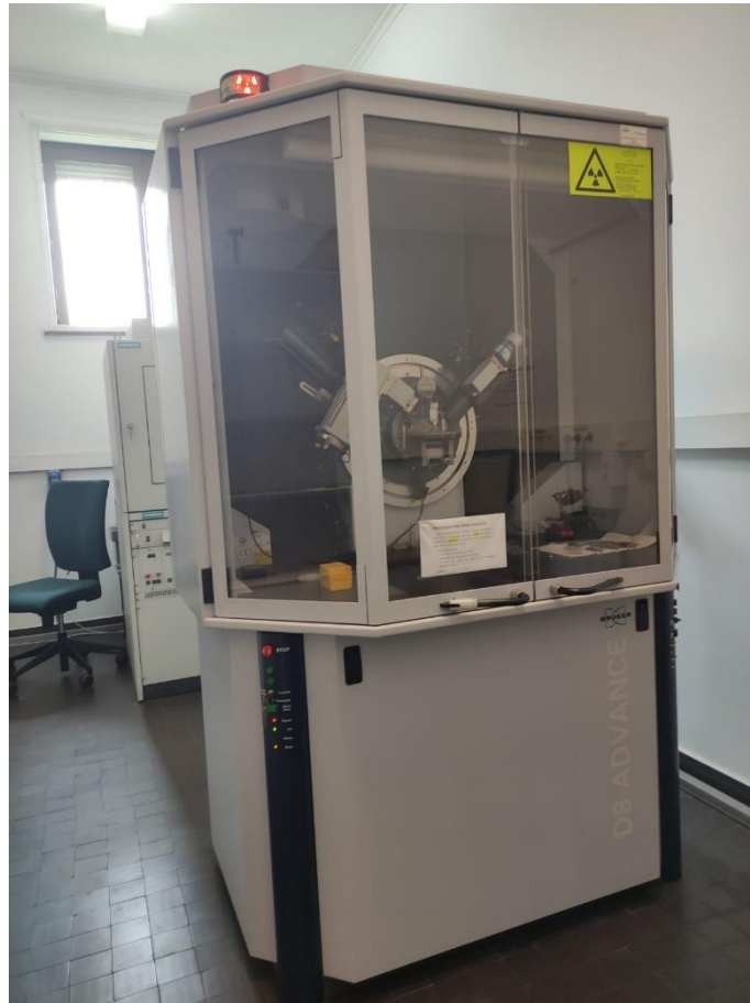
Figura 13. Equipo XRD; D8-advance diffractometer Brunker equipado con fuente de rayos X de \text{CuK}\alpha ( \lambda = 0.1541 \text{ nm} , 40kV, 40 mA) utilizado para muestras de este proyecto.
