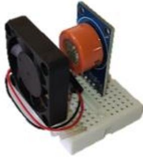
**Figura 3.8** Instalación mini ventilador y Módulo MQ3.
