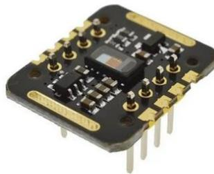
**Figura 3.3** Módulo Sensor de frecuencia cardíaca y Oxígeno Max30102.
