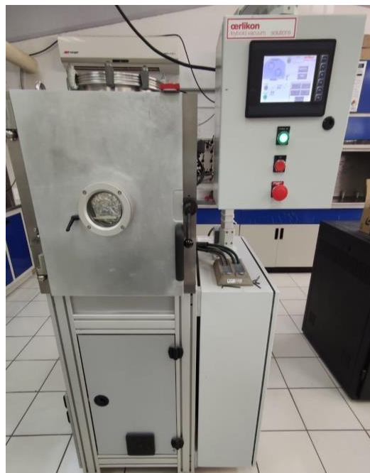
Figura 10. Equipo PVD modelo AErlikon leybold vacuum solutions para formación de película delgada de Aluminio.
