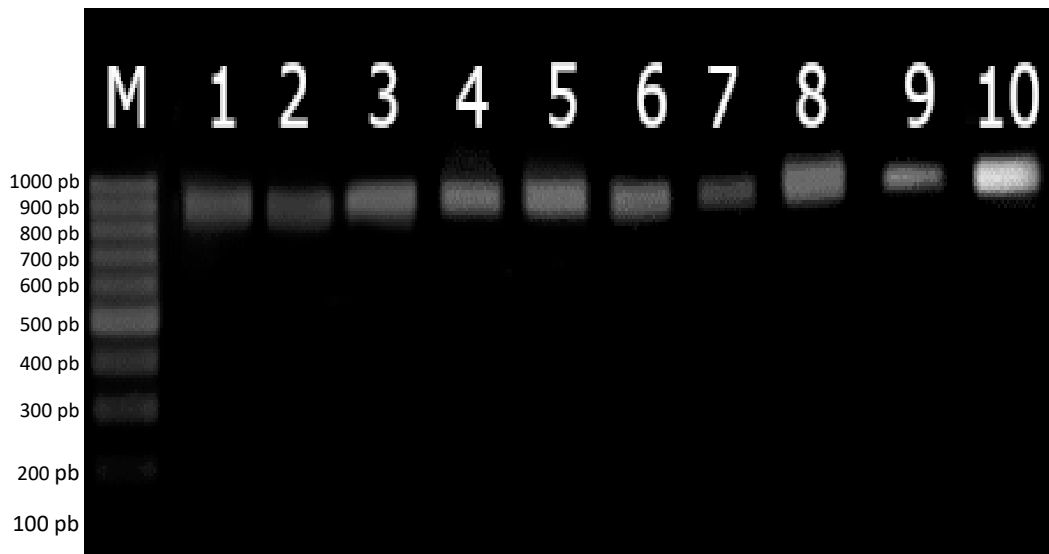
FIGURA 35. Electroforesis en gel de agarosa de los productos de PCR de la región ITS (850 pb). M representa el marcador de peso molecular de 100 pb; Los carriles 1 a 10 corresponden a los aislados: 009-4, 019-2, 026-2, 028-2, 029-2, 030, 032-2, 036, 044-1 y 062-1 T.r. respectivamente.
