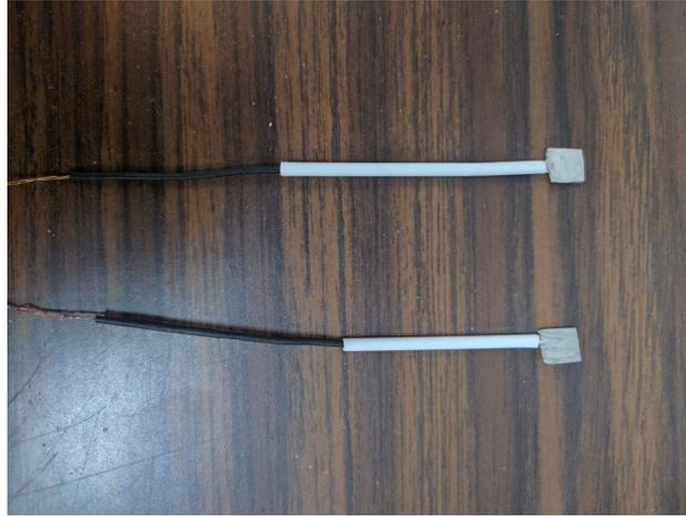
Figura 3.1: Electrodo de Cobre 6mm x 6mm
