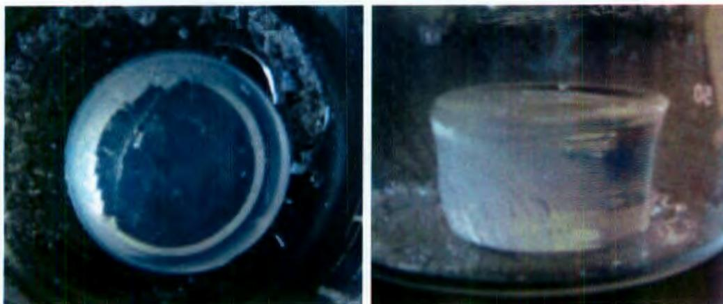
Figura 2.2. Sólido transparente obtenido a partir de carbonato amoniado de circonio después de un mes de curado.
