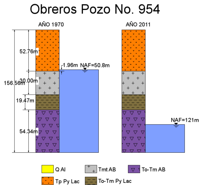
Figura 4.5.2 Espesores y Nivel de Abatimiento del Agua para el punto Roncopollo = Obreros en el Pozo 954.
