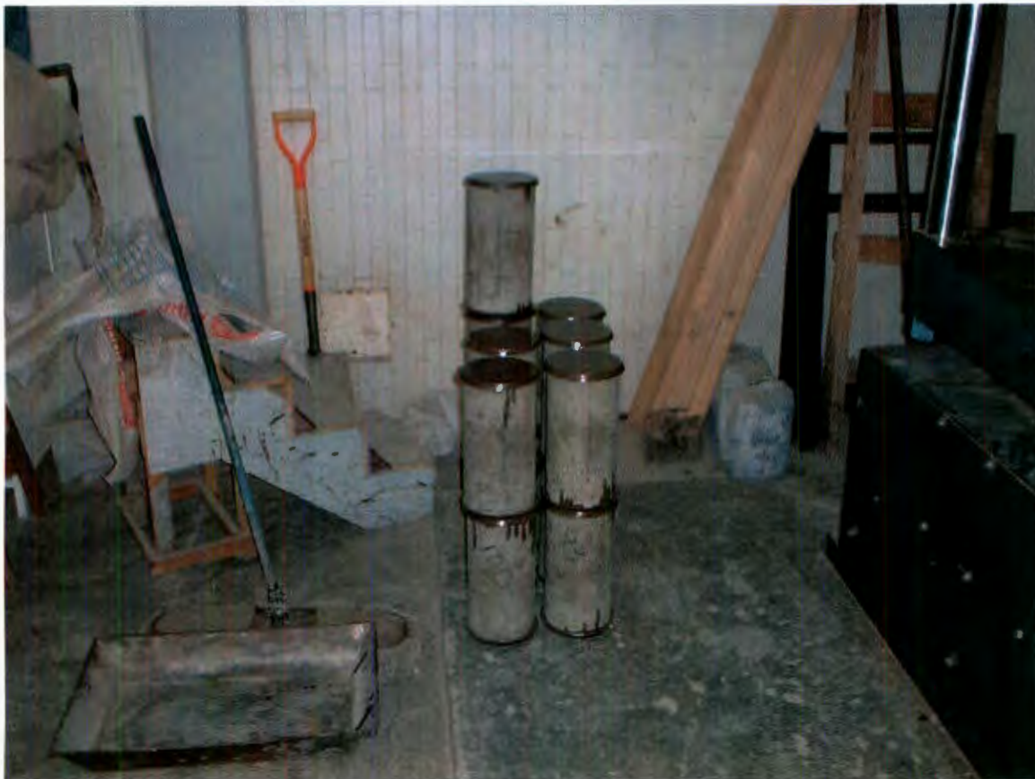
Figura 3.13 Cabeceo de cilindros de concreto con pasta de azufre
