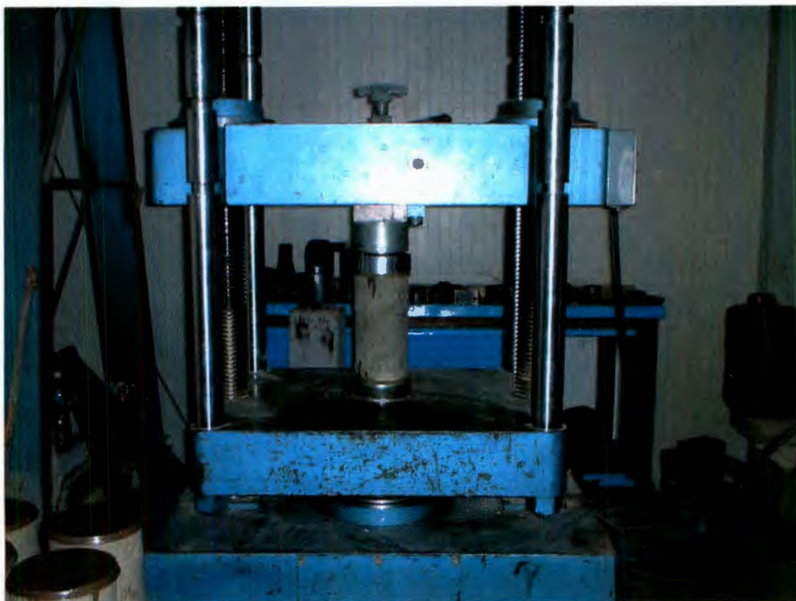
Figura 3.14 Pruebas de compresión a cilindros de concreto en la máquina universal. Marca "Forney" Modelo LT-1150 con capacidad de 150 toneladas
