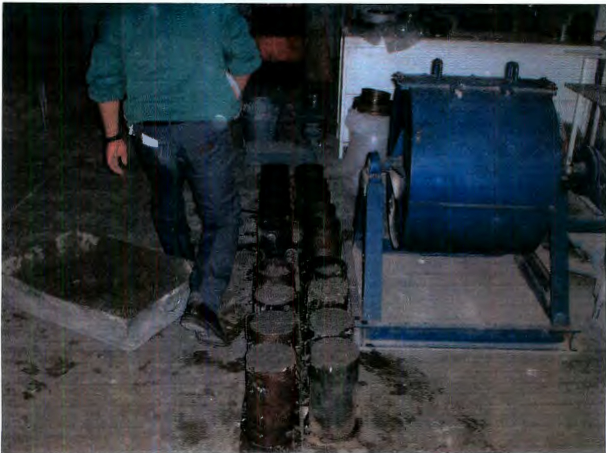
Figura 3.11 Elaboración de cilindros de concreto en los moldes de 15 x 30 cm
