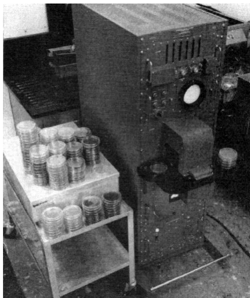
Figura 1.1. Contador automático de colonias microbianas desarrollado en los laboratorios Fort Detrick y Allen B. Du Mont (1957).
