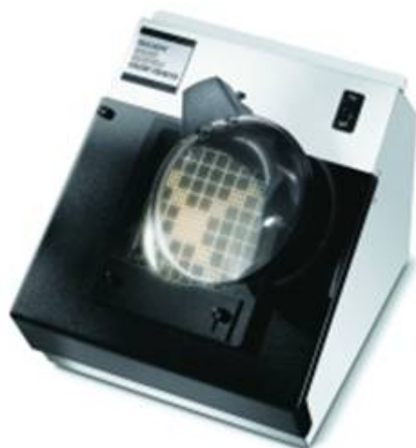
Figura 3.3. Contador de colonias manual ( Reichert Darkfield Québec , mod. 3325).
