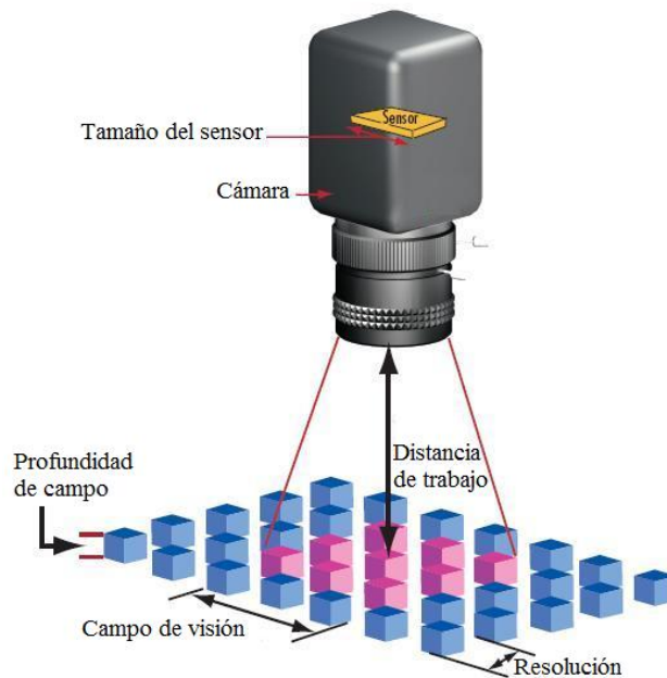
Figura 2.9. Parámetros fundamentales para la elección del lente ( Edmund Optics Inc., USA, 2007 ).
