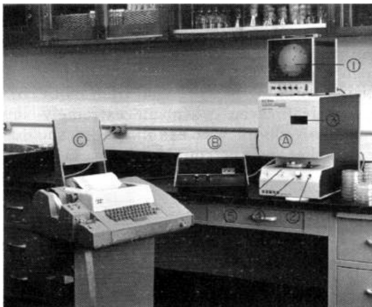
Figura 1.2. Equipo contador de colonias modelo 870 fabricado por Artek Systems Corp.
