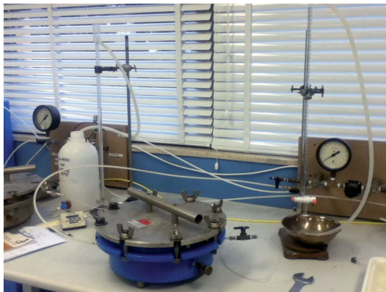
Figura VI.27 Esquema de la cámara de presión (superior). Imagen de la cámara de presión utilizada (inferior).
