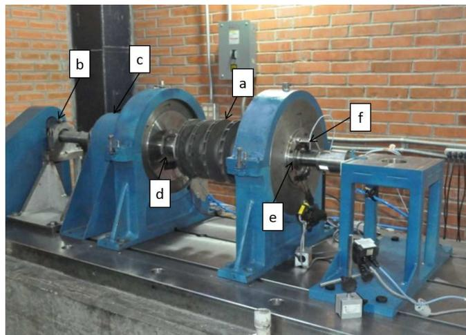
Figura 4.9. Banco de pruebas para experimentos sobre cojinetes de gas: a) rotor principal, b) motor eléctrico, c) multiplicador de velocidad, d) cojinete de gas en el lado acoplado al motor, e) cojinete de gas en el lado libre del rotor, f) sensor de proximidad.
