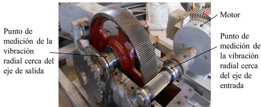
Figura 4.7. Transmisión mecánica de una etapa usada en las pruebas experimentales.
