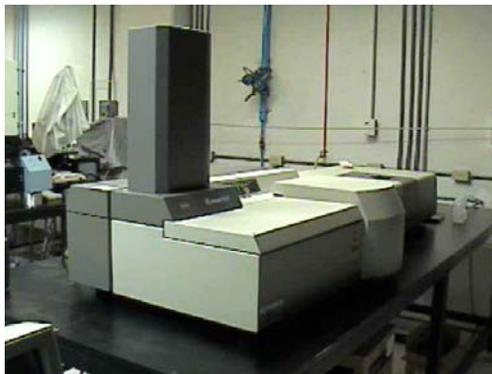
Figura 11. Espectrofotómetro FT-Raman.
