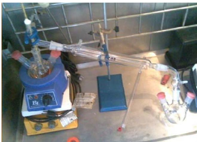
Figura 5. Sistema de destilación simple. En la figura se muestra el sistema de destilación armado para llevar a cabo la purificación de la anilina.
