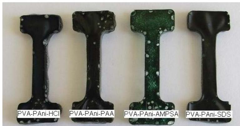
Figura 23. Compuestos de Polianilina (PANI-PVA) preparados a partir de PANI en dispersión. Se presentan imágenes de los compuestos que se utilizaron para la medición de las pruebas mecánicas.
