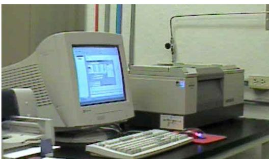
Figura 10. Espectrofotómetro infrarrojo con transformada de fourier.
