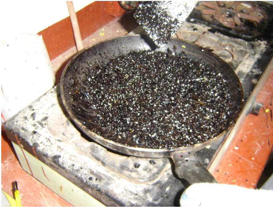
Foto 49 – Mezcla de agregado plástico – cemento asfáltico.
