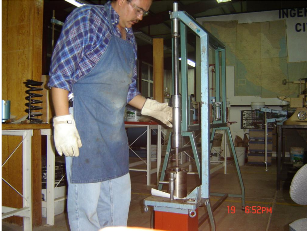
Foto 36 – Compactación del espécimen.
