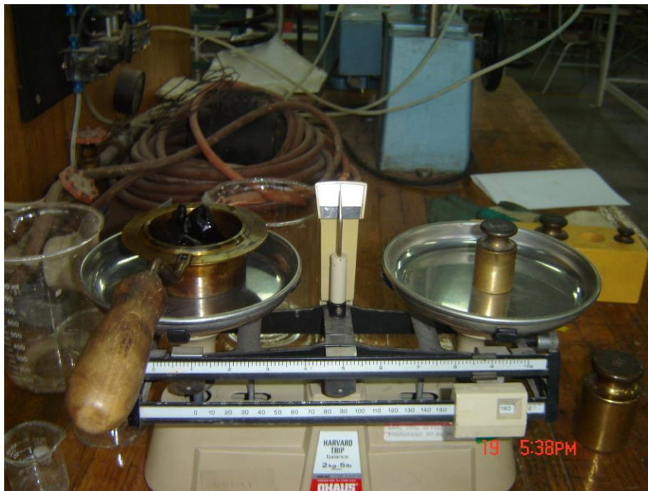
Foto 34 – Cantidad de cemento asfáltico.
