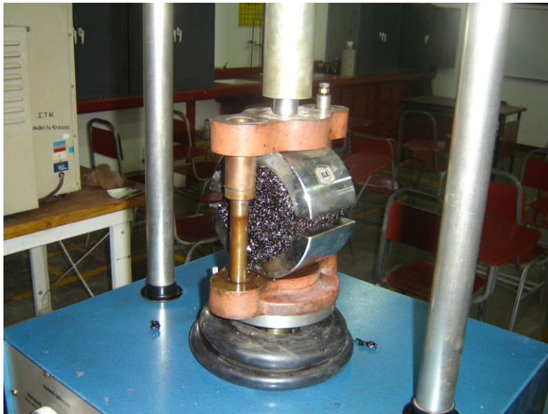
Foto 56 – espécimen de plástico en la prueba Marshall.
