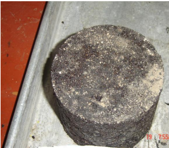
Foto 59 y 60 superficies de especímenes, mezcla común y mezcla con plástico.
