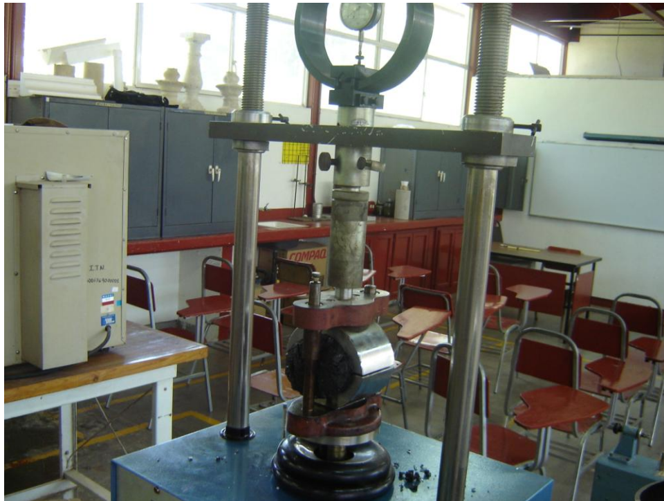
Foto 39 – Cilindro comprimido por la prueba Marshall.
