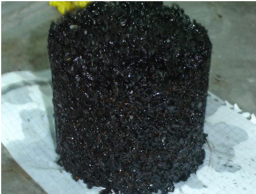
Foto 50 – Espécimen de prueba agregado plástico – cemento asfáltico.
