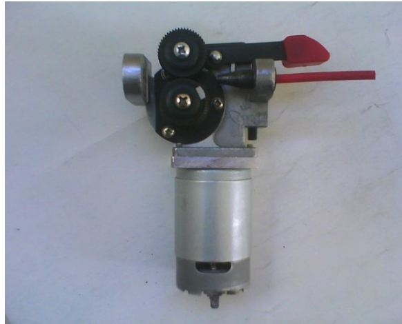
Figura 3.1 Transmisión de movimiento adquirida para la impulsión de varilla de aporte.
