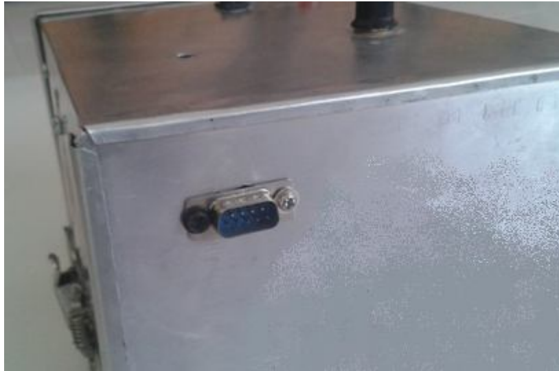
Figura 3.9 Conector DB9 para la comunicación con dispositivo.
