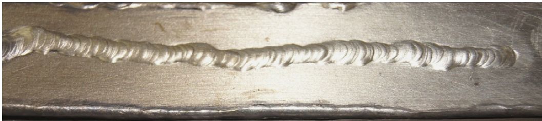
Figura 5.6 aplicación semiautomática de soldadura
