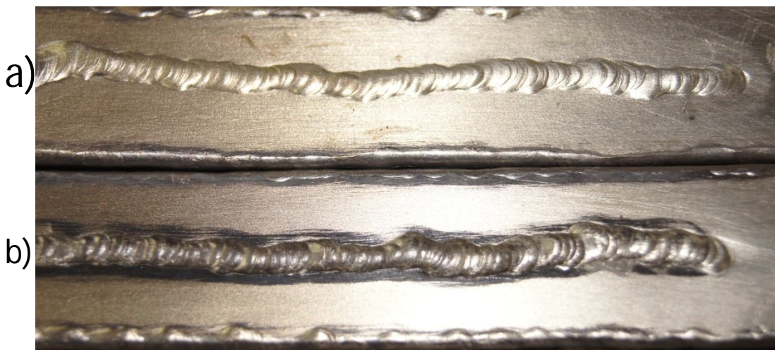
Figura 5.9 Probetas de soldadura a) aplicación semiautomática de soldadura b) aplicación manual de soldadura
