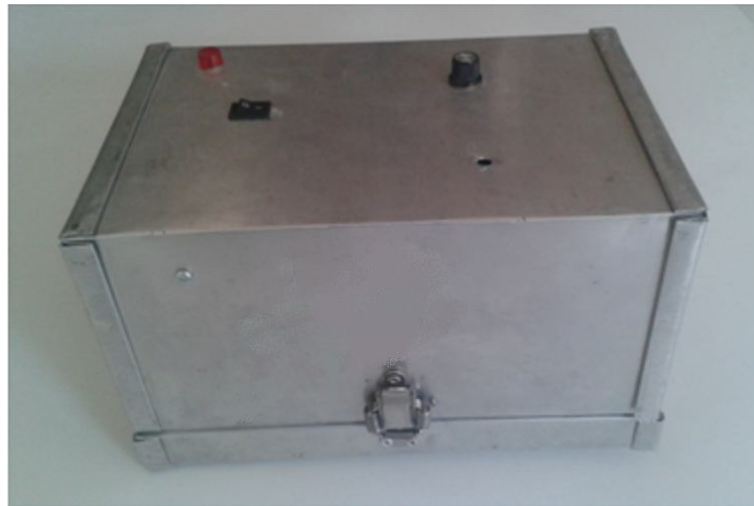
Figura 3.8 Caja de aluminio que contiene los elementos de control.
