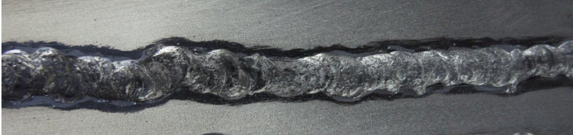
Figura 5.4 aplicación manual de soldadura
