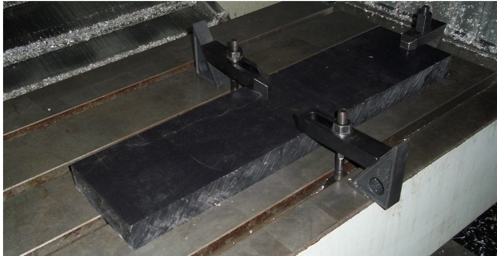
Figura 4.8 Sujeción del material base a mesa de coordenadas.
