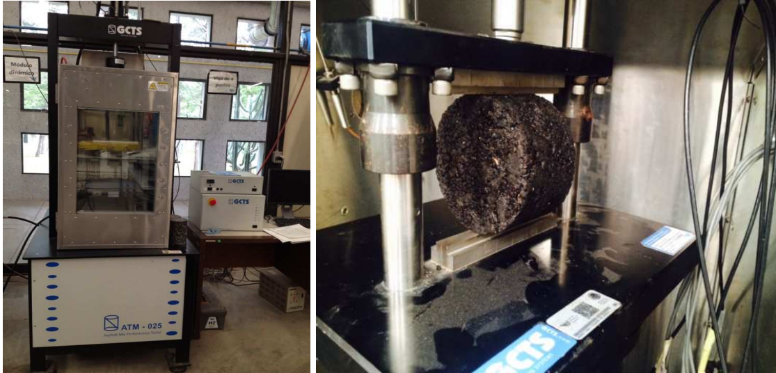
Figura 22a y 22b. Prensa servo-hidráulica marca GCTS y probeta montada en el equipo para recopilar la información y así obtener su curva esfuerzo-deformación.
