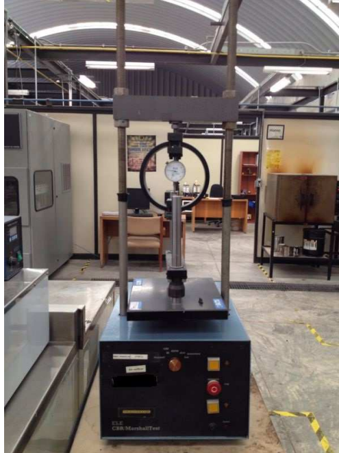
Figura 19. Probeta montada en la prensa Marshall marca ELE.
