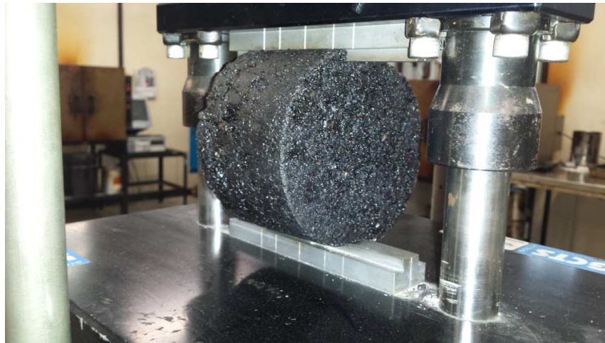
Figura 21. Probeta montada en la prensa para obtener la R. T. I.
