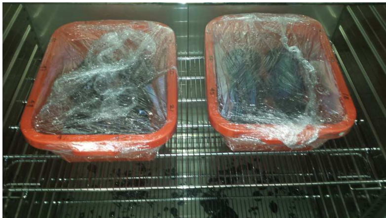
Figura 20. Proceso de inmersión de las probetas.
