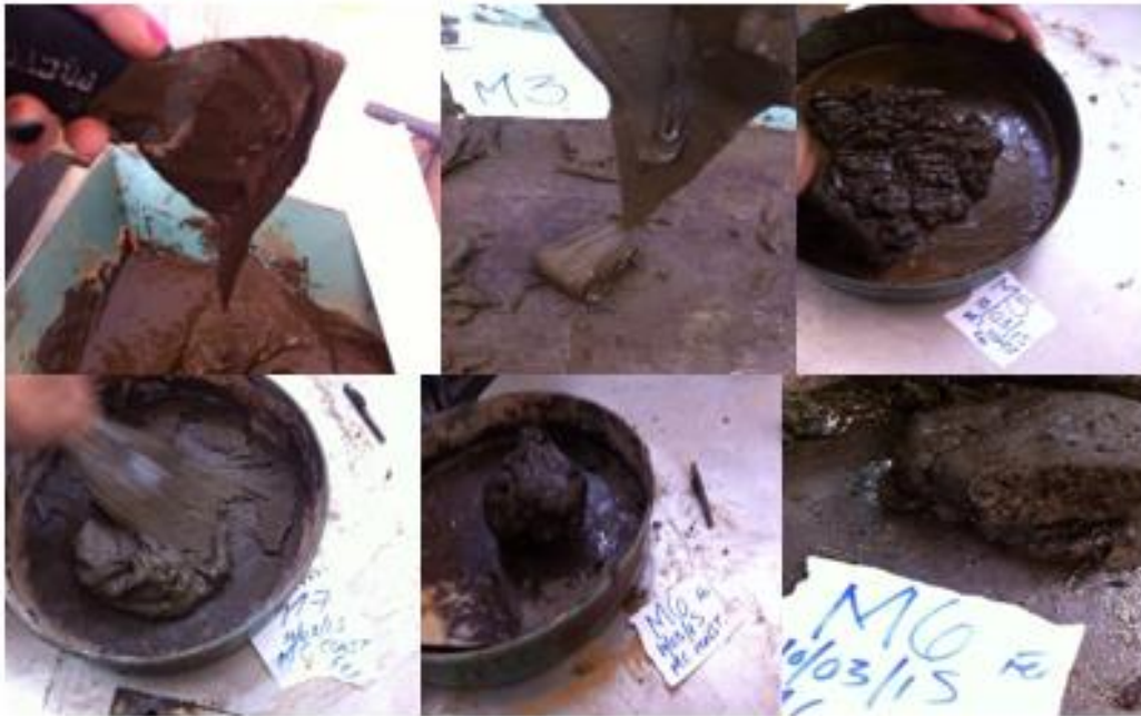
Figura 4.4 Proceso de desarrollo de cementante para concreto ecológico.
