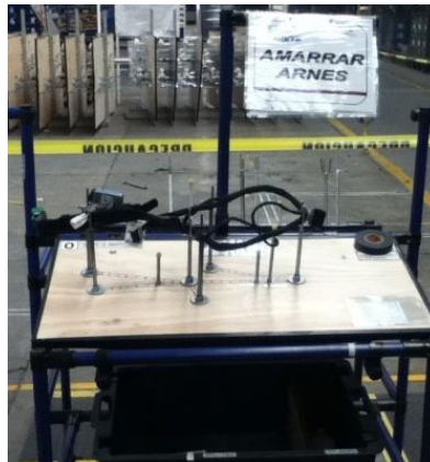
Figura 45. Tablero de amarres
