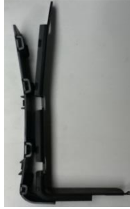
Figura 25. Canaleta para arnés
