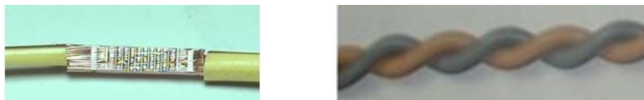
Figura 24. Empalme y trenzado
