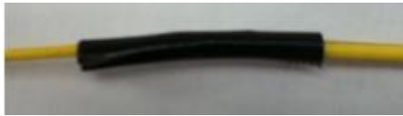
Figura 34. Aplicación de cinta Poliken
