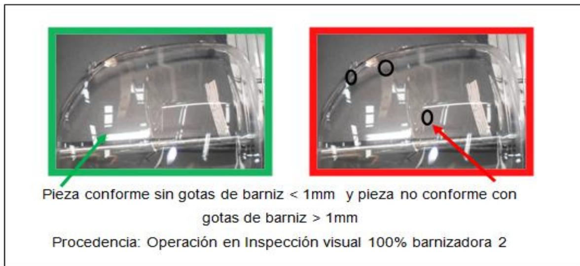
Figura 6.-Foto de pieza conforme y Pieza no Conforme Referencia: Valeo 2015
