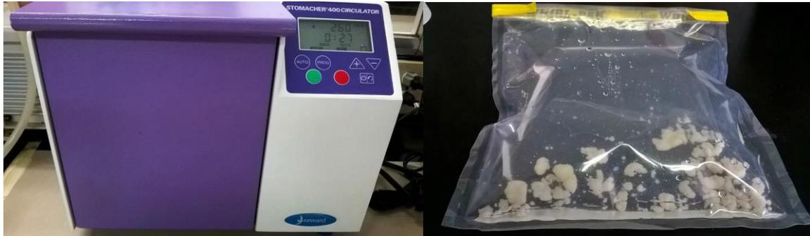
Figura 11. Homogenización de los gránulos de kéfir con el equipo Seward Stomacher<sup>®</sup> 400 circulator.
