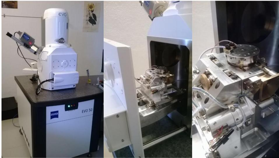
Figura 25. Microscopio electrónico de barrido Carl Zeiss (Mod. AG - EVO® 50) y colocación de muestras en el microscopio.
