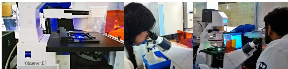
Figura 26. Visualización de las muestras en el microscopio de fluorescencia. Búsqueda del filtro y objetivo adecuado para una mejor observación.
