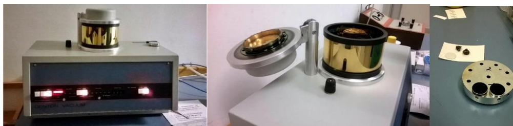
Figura 24. Recubrimiento con partículas de oro.
