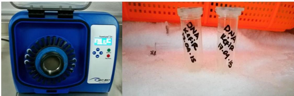
Figura 14. A) Equipo Homogenizador PowerLyzer® utilizado en el protocolo de extracción para lisar las células B) Muestras de DNA de kéfir listas para almacenamiento a -4 °C.
