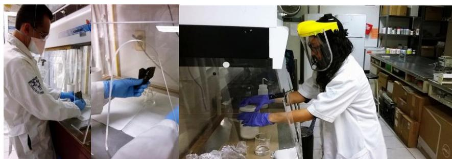
Figura 21. A) Manipulación del empaque de tetróxido de osmio B) Manejo de  $\text{OsO}_4$  en campana utilizando equipo de protección.
