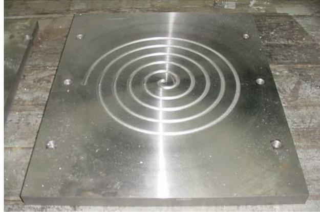
Figura 3.1. Espiral de Arquímedes con sección transversal circular.
