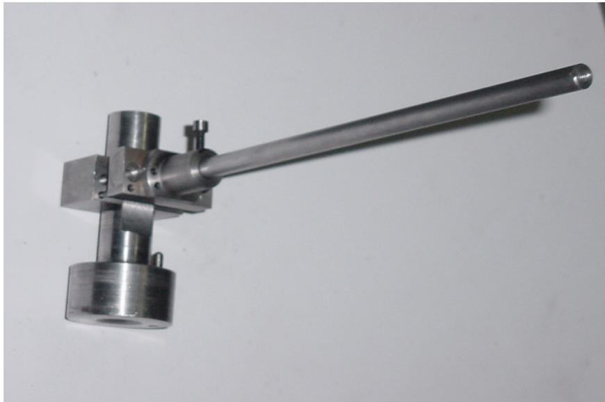
Figura 3.15. Transmisor montado sobre la boquilla.
