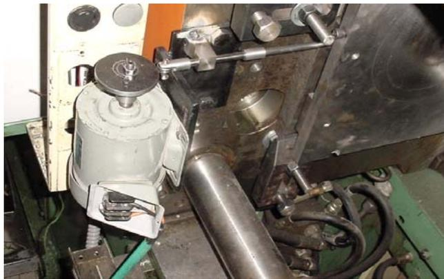
Figura 3.17. Montaje de mecanismo generador con respecto al molde.
