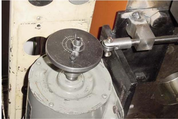
Figura 3.18. Mecanismo leva-seguidor.
