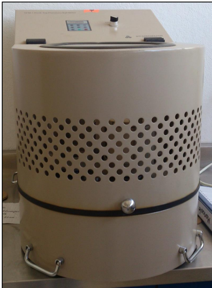
Figura 5. Molino planetario marca “MTI CORPORATION” modelo “SFM-1”.
