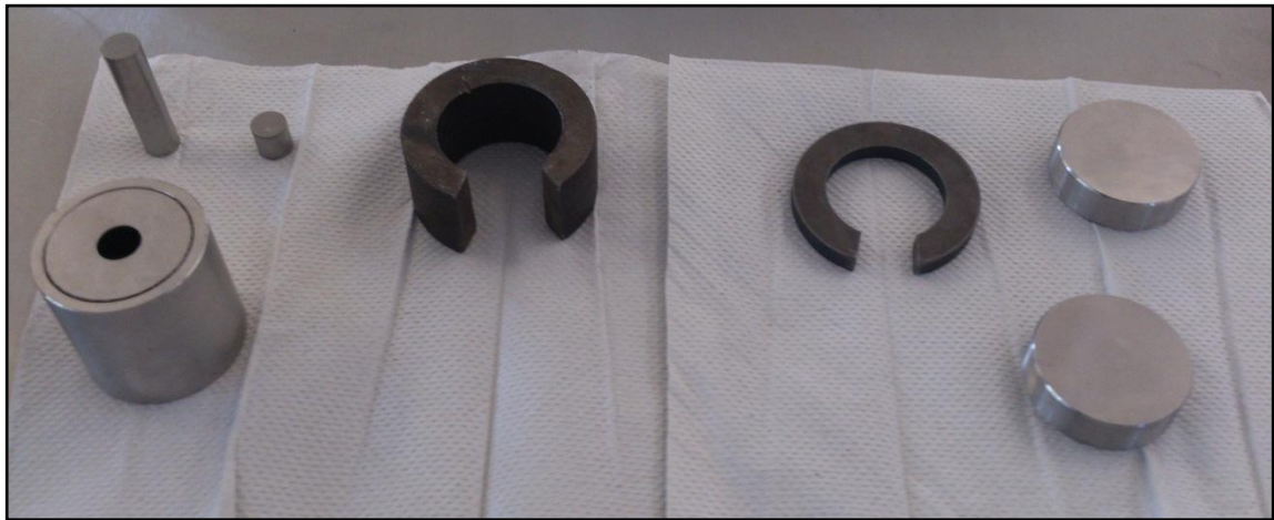
Figura 10. Juego de dados y vástagos para prensado en seco.
