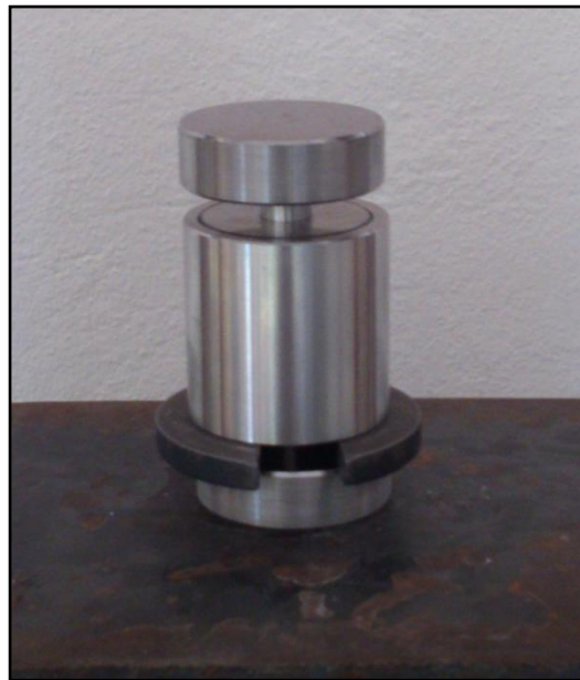
Figura 14. Juego de dados correctamente armado.
