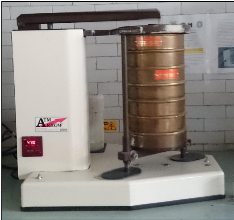
Figura 4. Ro-tap marca "ATM ARROW" y tamices.
