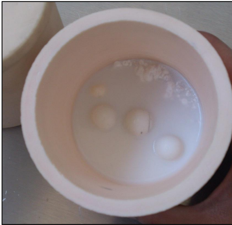
Figura 7. Recipiente con mezcla de Al_2O_3 - SiO_2 (Sílice intrínseca).
