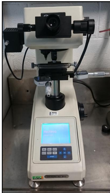
Figura 26. Microdurometro Vickers Willson Hardness Modelo 402 MVD.
