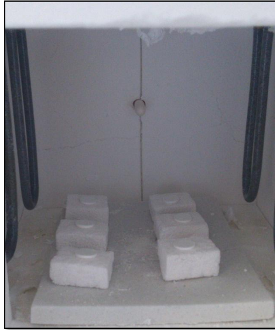
Figura 19. Posición de las pastillas por lotes dentro de la mufla.
