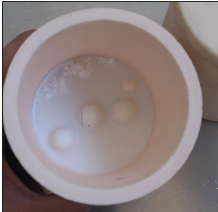
Figura 6. Recipiente con mezcla de \text{Al}_2\text{O}_3 - \text{SiO}_2 (Sílice preparada).
