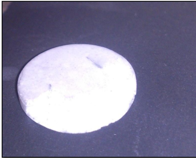
Figura 21. Pastilla quebrada, pasada por la lija número 2000.
