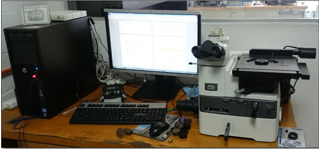
Figura 27. Equipo Nikon Eclipse MA200 con software NIS Elements.
