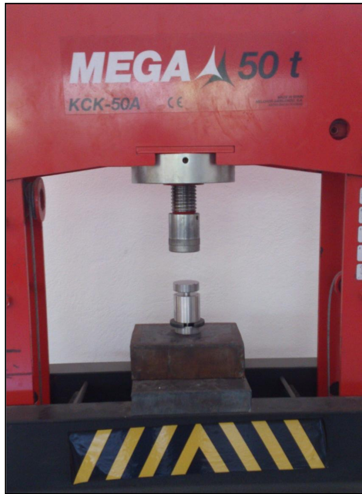
Figura 9. Prensa marca “MEGA”, modelo “KCK-50A” de 50 toneladas.
