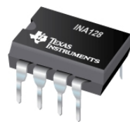
Figura 3-8.- Amplificador de Instrumentación INA128. (Texas Instrument, INA128, 1995)
