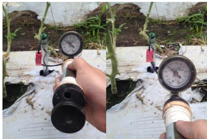
Figura 14.3.4 Colocación del lisímetro o chupatubo
