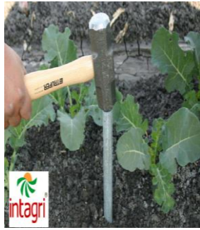
Instalación de tensiómetros en campo
