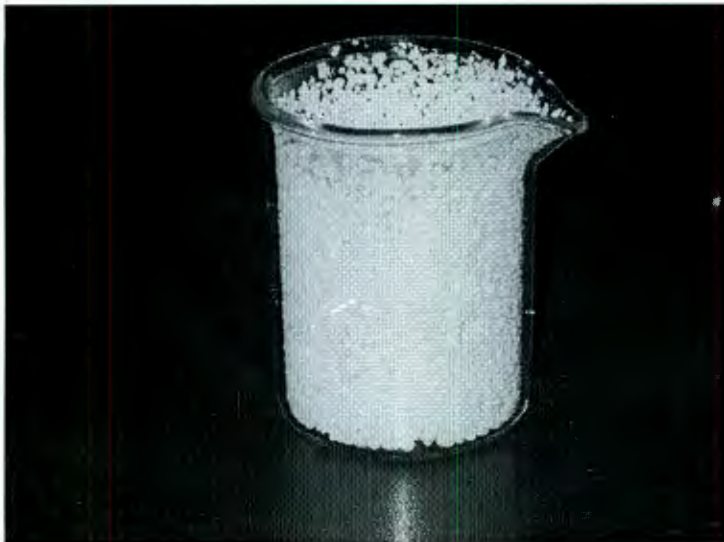
Figura 4.13 Esferas de poliestireno expandido utilizadas para generar los poros en la espuma cerámica.
