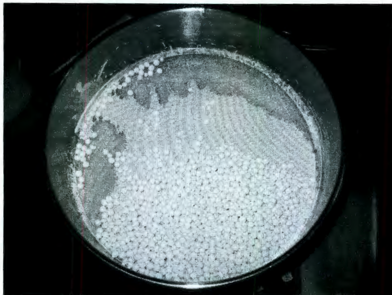
Figura 3.11 Bolas de alúmina retenidas en la malla para separarlas de la suspensión después de la molienda.
