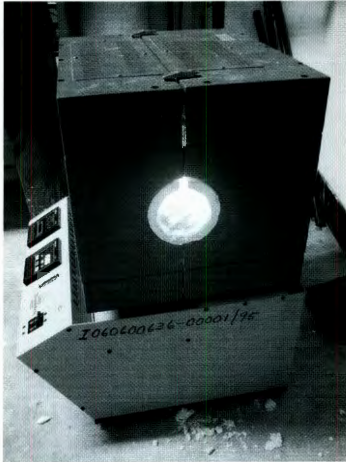
Figura 3.16 Horno de tubo de alta temperatura para sinterización de cerámicos facilitado por el Laboratorio de Ingeniería Mecánica del Instituto Tecnológico de Celaya.
