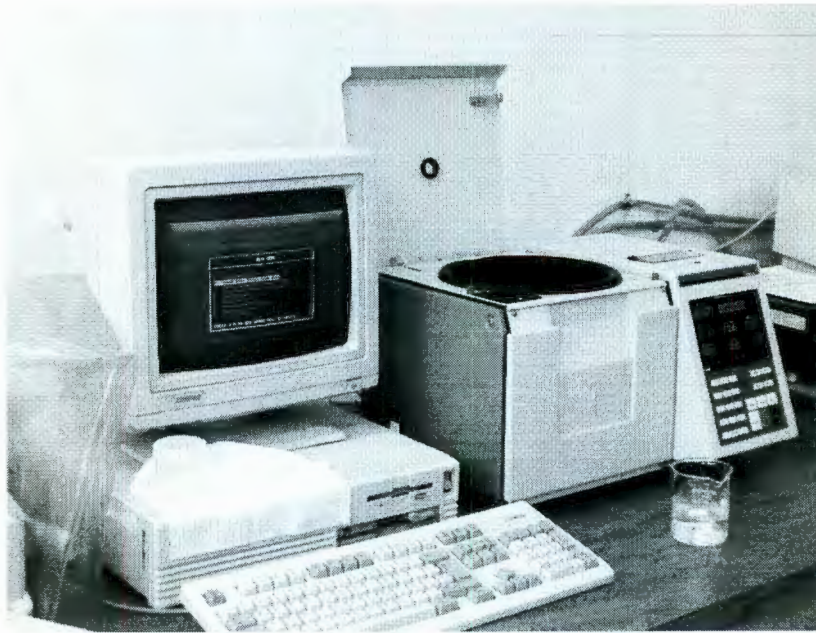
Figura 3.27 Medidor de tamaño de partícula Schimadzu Centrifugal Particle Size Analyzer SA-CP4.
