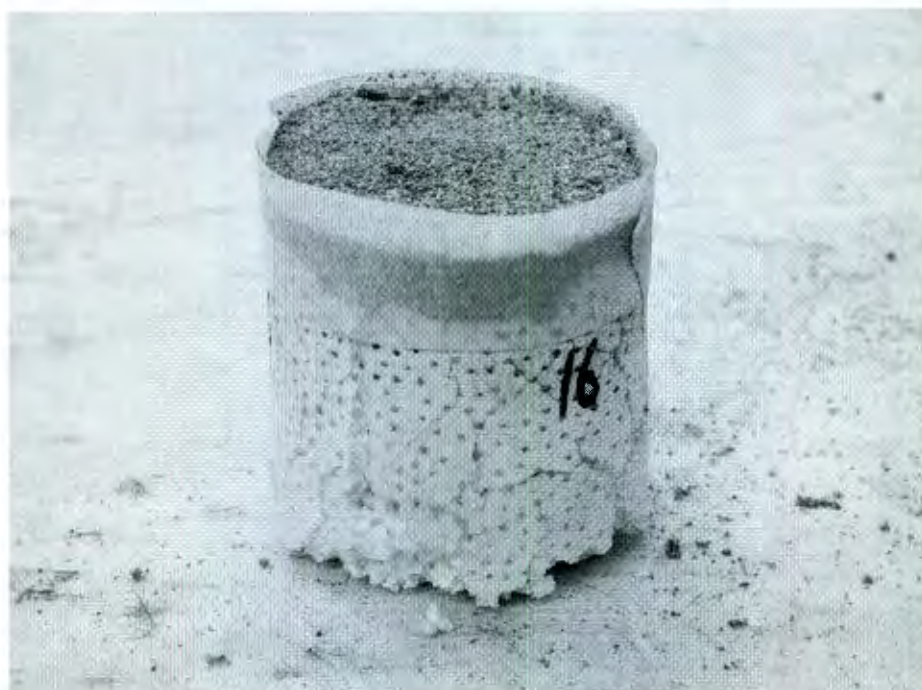
Figura 3.32 Colocación de arena en la cara superior de una probeta antes de un ensayo de compresión simple.
