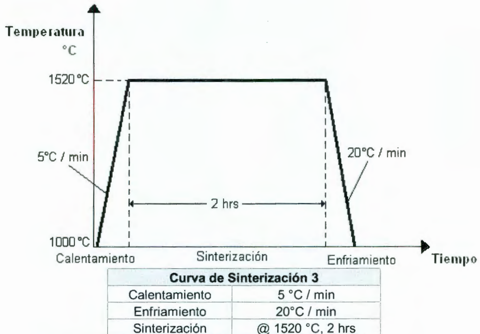
Figura 3.21 Curva de sinterización no. 3 utilizada para Ensayos 4.
