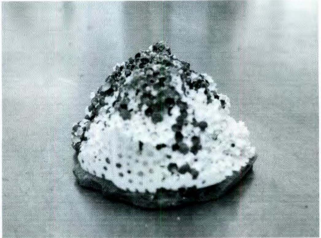
Figura 4.30 Espuma cerámica base alúmina ensayada a compresión simple. Se puede observar que la falla ocurrió a 45^\circ en ambos lados, lo que indica que el ensayo se realizó conforme a las especificaciones.
