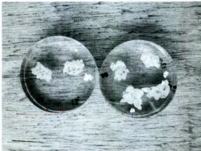
Figura 3.26 Muestras montadas de las espumas en baquelita y posteriormente recubiertas con una fina película de oro.
