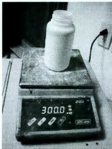
Figura 3.1 Preparación de una mezcla de polvos para un Ensayo B (300 gr de polvos de Al_2O_3 RG – 100 y Caolín con una relación de 350:50 en peso) utilizando una báscula electrónica.
