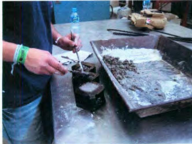
Figura 7.4. Llenado de los moldes con la mezcla
