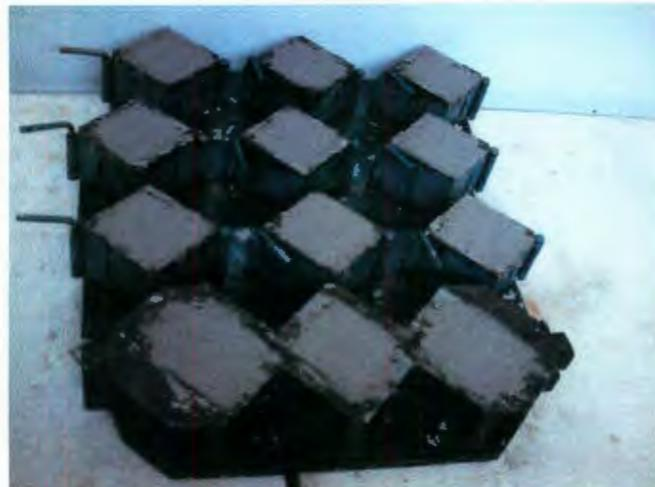
Figura 7.5 Moldes cúbicos llenos con mezcla de mortero
