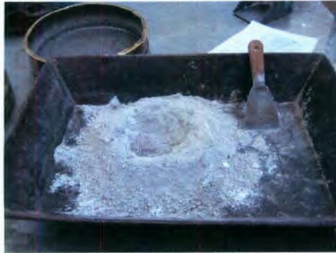
**Figura 7.2. Mezcla de los materiales en forma de volcán**
