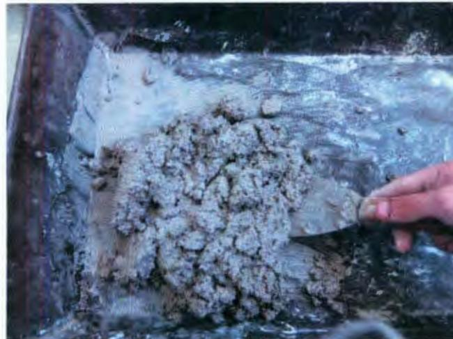
**Figura 7.3 Mezcla de mortero cemento-cal-arena**
