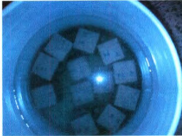
**Figura 7.8 Muestras sumergidas en el cloruro de sodio.**
