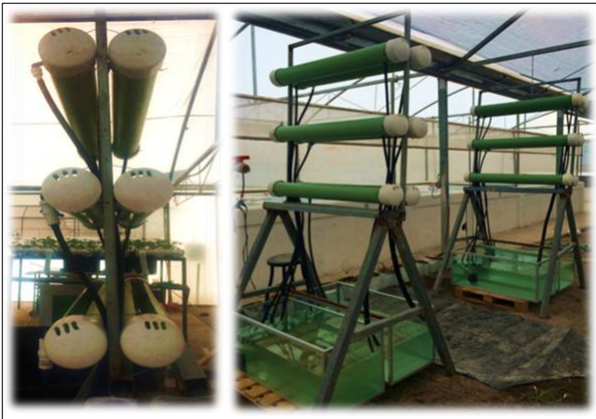
Figura 13 Prototipo II. Ensamblado, pruebas de resistencia y pruebas de caudal hechos previamente al tiempo de 90 días de los sistemas Acuapónicos.
