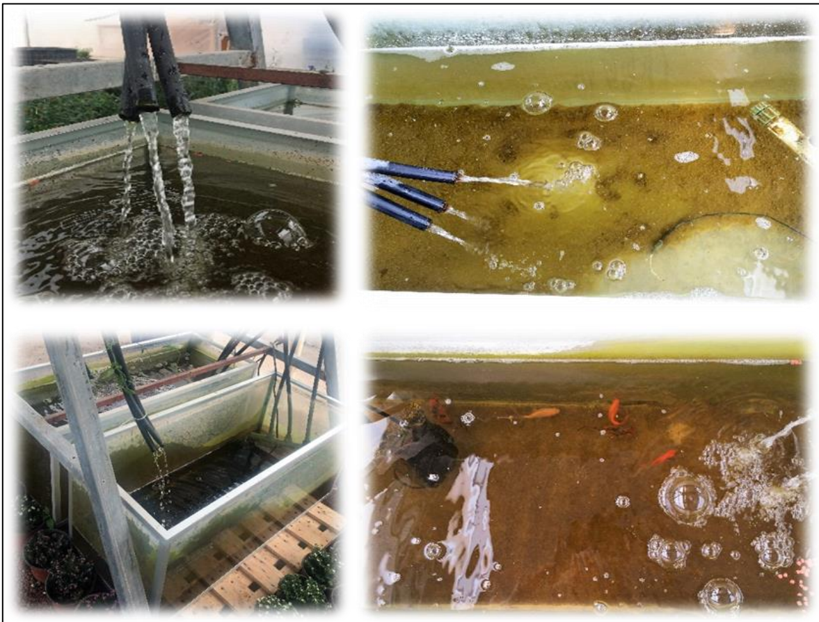
Figura 14 Pruebas de caudal, drenaje y sedimentación de agua sin organismo acuático y de agua con organismo acuático. Duración 15 días.
