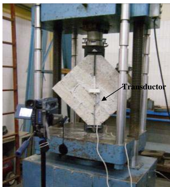
Figura 3.12 Arreglo experimental sobre la cara frontal del murete
