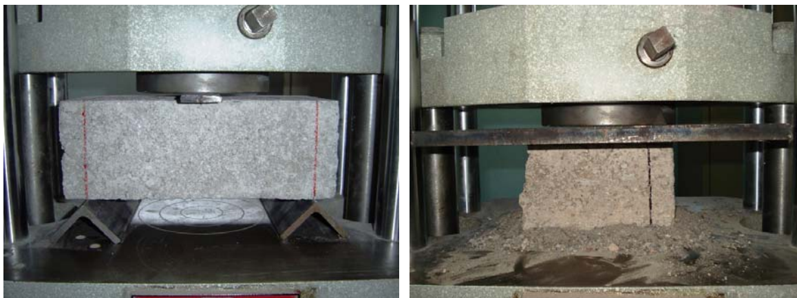
Figura 3.3 a) Ensayo de módulo de ruptura en tabiques, b) Ensayo de compresión simple
