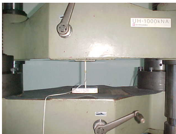
Figura 3.6 Ensayo de tensión de varillas FRP
