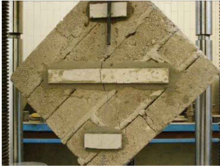
Figura 4.13 Murete ensayado reforzado con geopolimérico (RG1CE)
