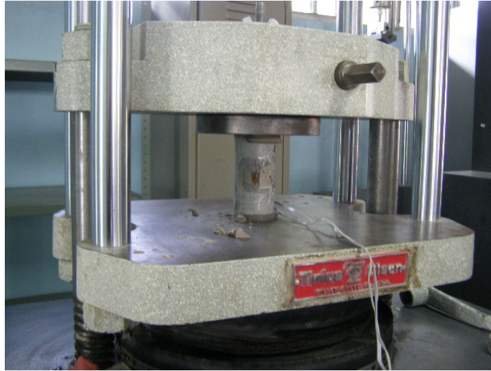
Figura 3.4 Ensayo de compresión simple en mortero con cemento Pórtland
