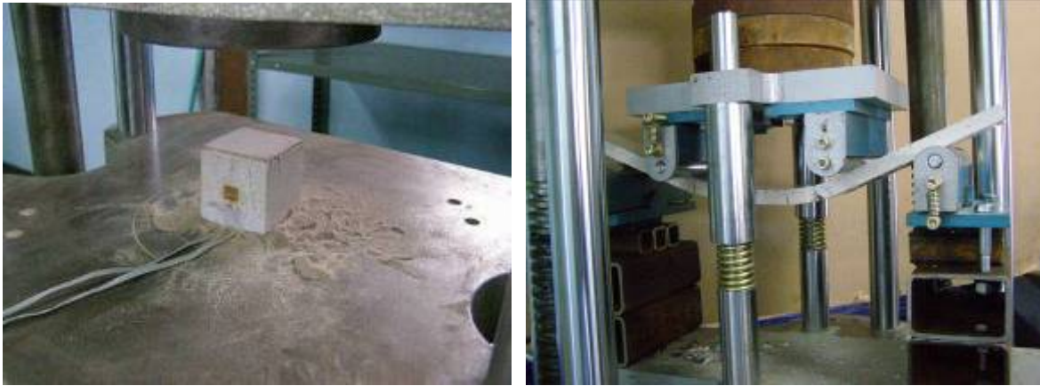
Figura 4.2 Ensayo a compresión y flexión de morteros geopoliméricos
