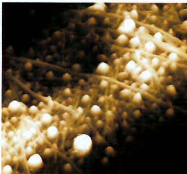
Figura 1. Microfotografía, fibrillas de celulosa en unión con lignina (zonas esféricas) y hemicelulosa (Himmel, 2009).
